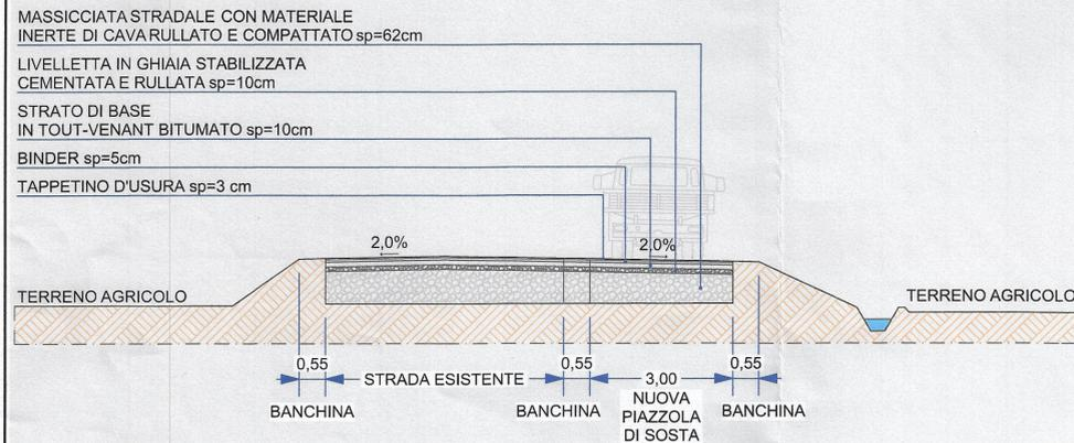
PIAZZOLA DI SOSTA Stato di progetto - sezione A - A (scala 1:100)
